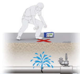
Точечное обнаружение местоположения течи с помощью универсального геофона или универсального приёмного устройства и треноги
