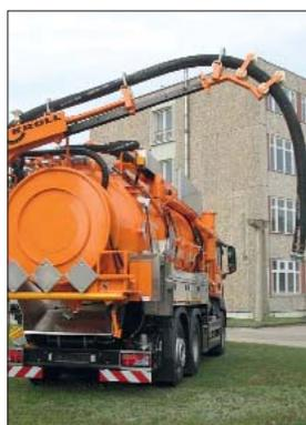
Большой барабан с телескопической стрелой (утепленный вариант)
