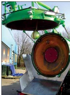
Система слива при помощи пневмопоршня
