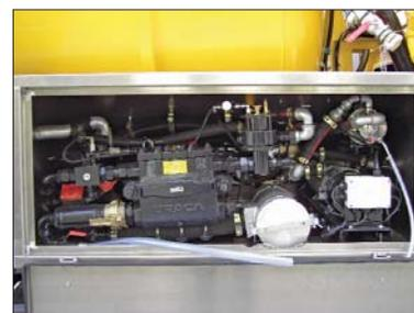
Насос высокого давления URACA (утепленный вариант)
