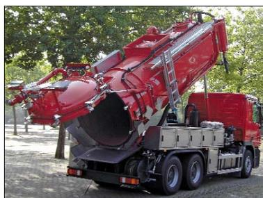
Система слива при помощи опрокидывания
