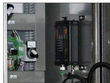
Модуль GSM - обеспечивает быстрый доступ для диагностики навесного оборудования с завода-изготовителя
