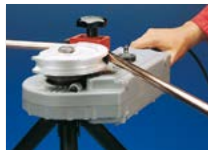
При использовании дополнительной треноги осуществлять работы трубогибом можно на удобной высоте
