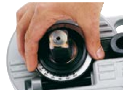
Ручная настройка угла гибки от 0 до 180°
