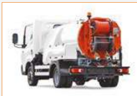
ROM Smart Combi Комбинированная установка для промывки и откачки (вакуум и высокое давление)
