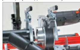
Насадка на торцеватель (№ 54040) (спец. принадлежность)
