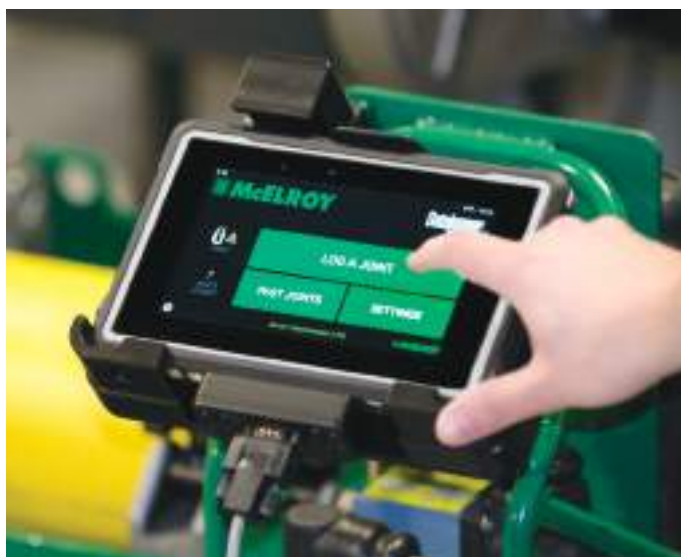
Сварщик использует DataLogger® 6 для записи процесса сварки
