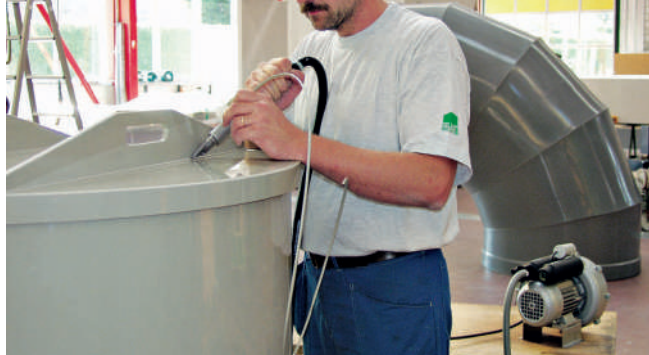
Вентилятор ROBUST подаёт воздух к WELDING PEN
