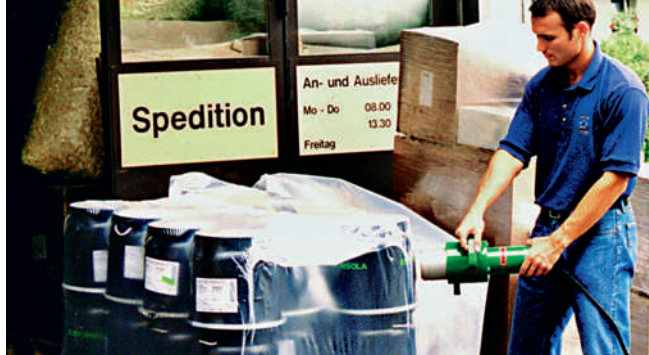
Усадка термоусадочной плёнки на палетах без использования открытого пламени в закрытых помещениях
