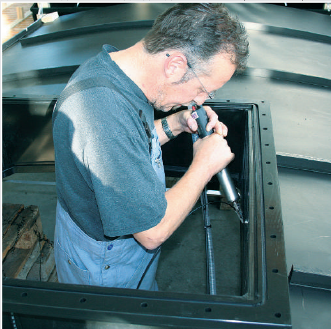
DIODE S используется при сварке деталей на баке
