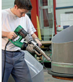
Экструдер FUSION 3C при сварке резервуара
