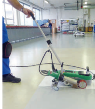
Стабильное качество сварки внахлёт
