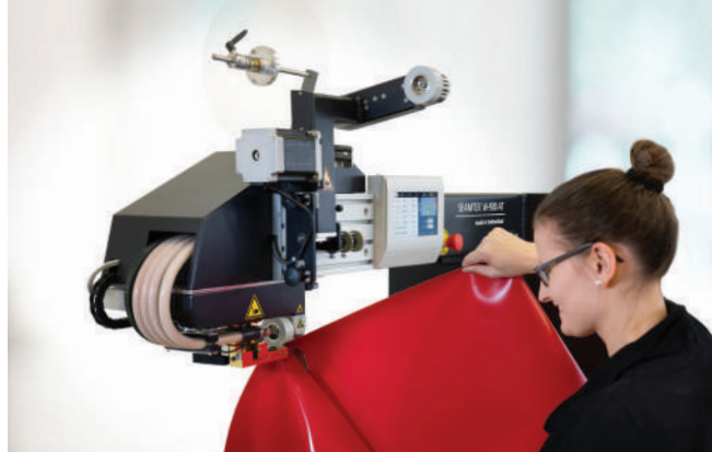
Инновационная технология горячего клина
