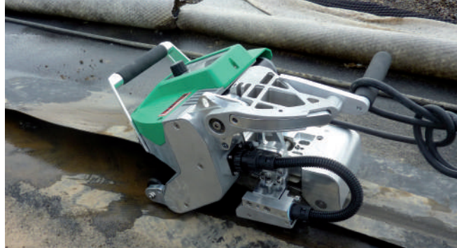
GEOSTAR G5 — сварка геомембраны ПЭНД
