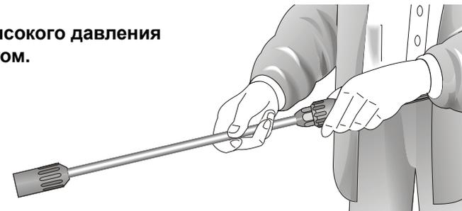
3. Шланг высокого давления размотать без образования петель и соединить с ручным пистолетом и насосом. При наличии удлинителя использовать шланг высокого давления макс. 20 м или 2 шланга по 10 м с шланговыми соединителями.
