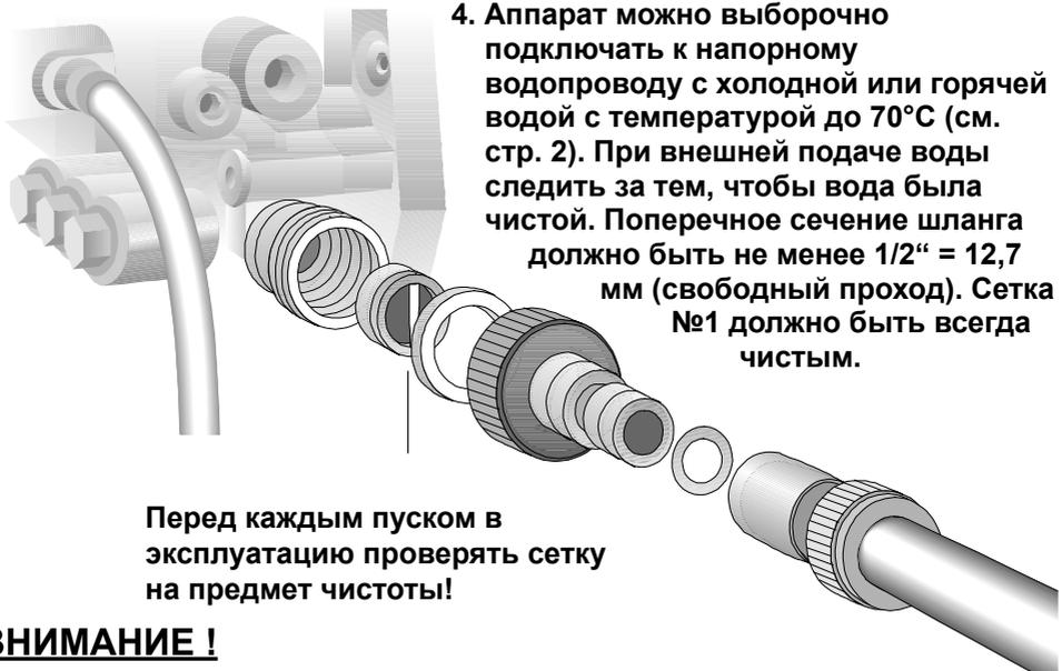
4. Аппарат можно выборочно подключать к напорному водопроводу с холодной или горячей водой с температурой до 70°C (см. стр. 2). При внешней подаче воды следить за тем, чтобы вода была чистой. Поперечное сечение шланга должно быть не менее 1/2" = 12,7 мм (свободный проход). Сетка №1 должно быть всегда чистым.
