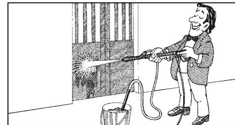
Очищение пескоструйным соплом остатков краски, ржавчины и фасадов. Пескоструйный инжектор со всасывающей насадкой и 3-метровым шлангом из ПВХ и ниппелем ST30
