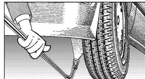
Мойка днищ автомашин, автопоездов и оборудования. Копье 90 см с соплом высокого давления и ниппелем ST 30 M 22 x 1,5.
