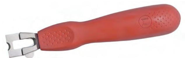
Используется для удаления выступающей части прутка после сварки. Нож имеет режущее лезвие и насадку для предварительного реза. Подрезка происходит только в зоне сварки, что позволяет избежать лишних надрезов линолеума.
