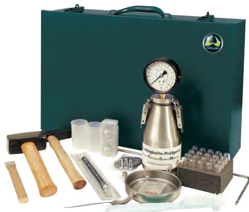
Полный комплект оборудования, необходимого для замера остаточной влажности в стяжке и бетоне. В металлическом чемодане для транспортировки.
