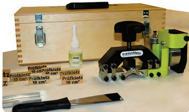
Специальный измерительный прибор для оценщиков и экспертов в индустрии напольных покрытий. Для измерения прочности на сдвиг таких оснований, как стяжка, наливной и деревянный полы.
