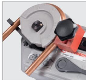
Предварительная настройка угла гибки без использования инструмента
