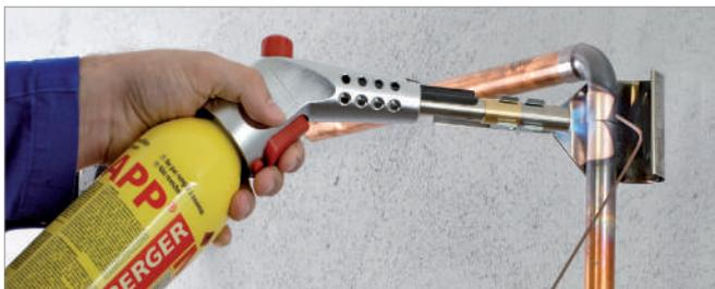
Высокая температура пламени благодаря циклонному завихрению
