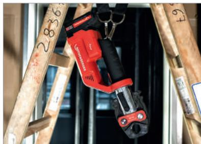
Конструктивное исполнение с 2 цилиндрами позволяет удобно работать одной рукой
