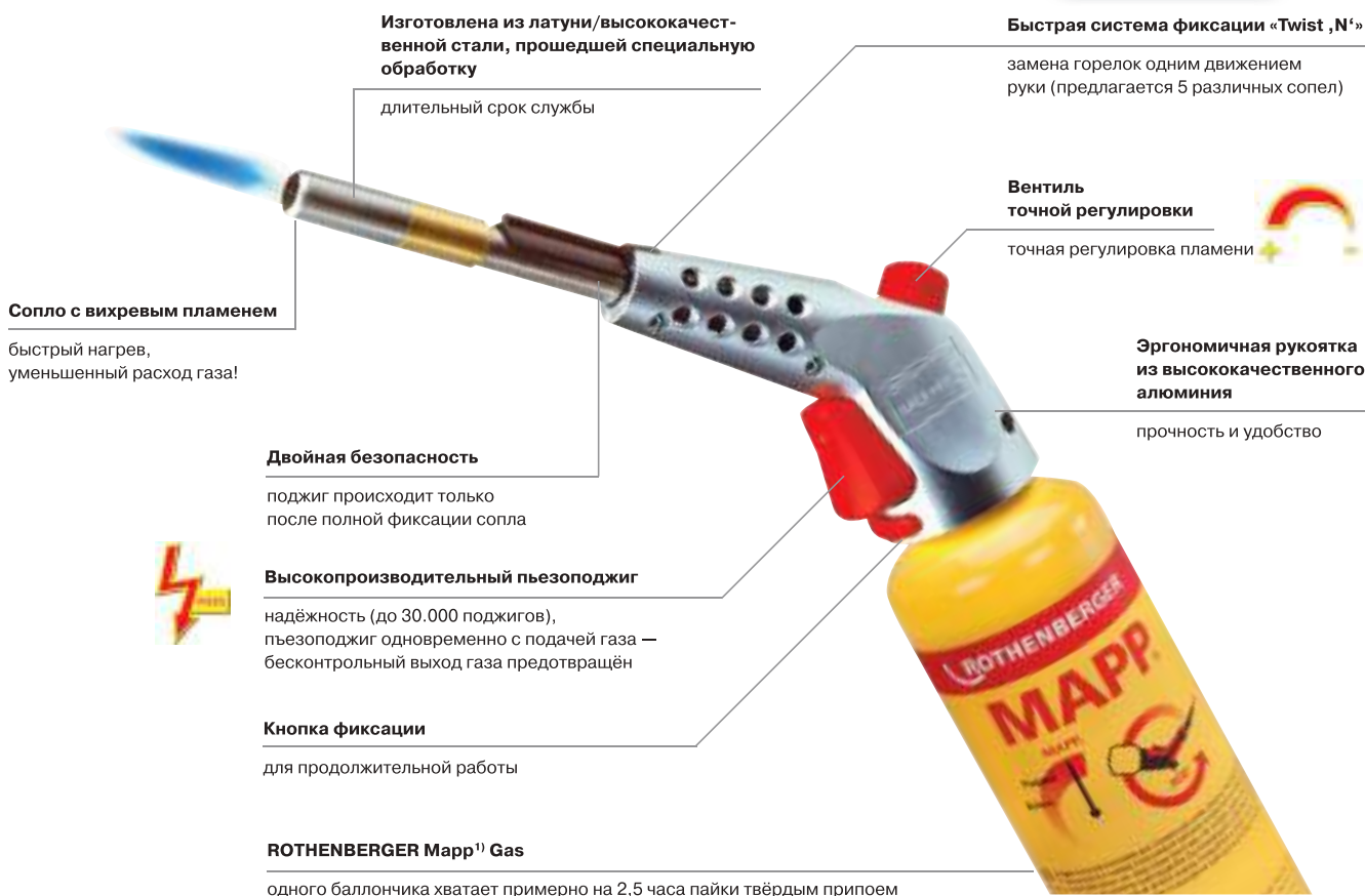
Высокая температура пламени благодаря циклонному завихрению
