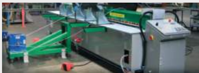
Осуществляет сварку посредством встроенной системы ЧПУ, включающей базу данных для сварки термопластов PE, PP, PVC-U и PVDF
