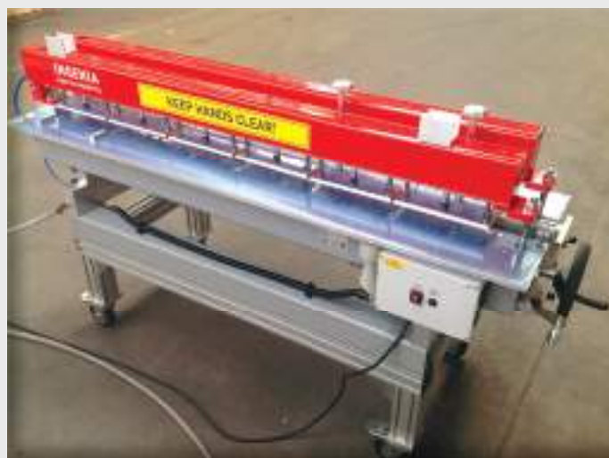
Ручные сварочные машины для выполнения работ небольшого объёма
