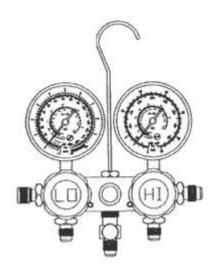
Четырехпозиционный манометрический коллектор со шлангами - инструкция по применению при заправке фреоновых систем кондиционирования и холодильного оборудования.
